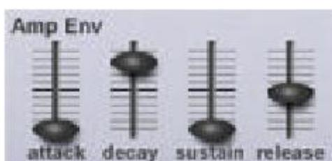
サウンドの“シェイピング”（音の鳴り方=音量変化）を決定する、**4** ステージのエンベロープジェネレーターです。この設定によりアタックの強いパーカッシブなサウンドや、ゆっくりしたアタックのレガートサウンドなど、幅広い表現ができます。
