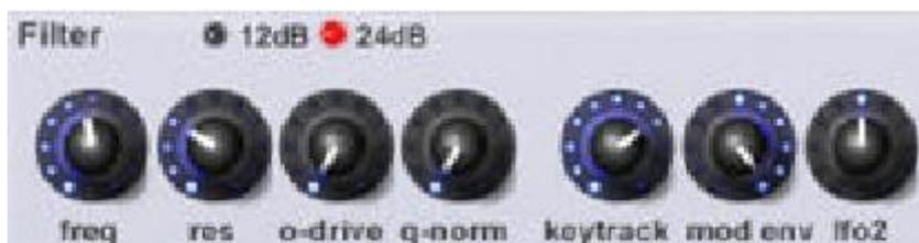
V-Station のローパスフィルターは **Novation** 社の“リキッドアナログ”テクノロジーの心臓部ともいえるもので、「本物」のアナログフィルターの特性を再現しています。このフィルターは自身のエンベロープジェネレーターか、**LFO2** で変調可能です。レゾナンス (**res**) は平坦なサウンドから強力なクセを持ったサウンドまで作り出し、エッジ感を付加します。オーバードライブ (**o-drive**) はサウンドを歪ませます。フィルター特性は **12dB** と **24dB** の切り替えです。**12dB/oct** では、日本製のオールドシンセの特性を再現します。また **24dB/oct** ではよりパンチのある特性となり、アメリカ製のオールドシンセに近い感じを出せます。
