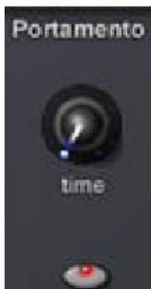
このノブ（**time**）を調節することにより、各ノート（音程）間をなめらかに変化させることができ、**Roland TB-303** の“**Slide**”ファンクションを再現したり、ビンテージシンセのニュアンスを再現したりできます。なおこの機能は、モノフォニックでもポリフォニックでも動作します。
