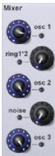
この **5** チャンネルミキサーは各オシレーターの音量バランスを取るために使います。またそれ以外にリングモジュレーター (**ring**) とノイズジェネレーター (**noise**) をミックスすることで、特殊な効果も得られます。リングモジュレーターはオシレーター **1** と **2** の信号を基につくられ、異なる周波数の信号をつくり出します。例えば不協和な感じや金属的なサウンドを得られます。
