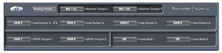
Die Routing-Sektion zeigt jeden Hardwareausgang des Saffire PRO 24. Hier wählen Sie jeweils den Audiodatenstrom, der zu diesen Ausgängen gesendet wird. Nutzen Sie zur Auswahl das Drop-Down-Menü links des jeweiligen Ausgangs.
