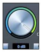
Mit diesem Regler werden die Pegel aller zugewiesenen Ausgänge geregelt. Der Ausgangspegel kann mit der Maus eingestellt werden und wirkt auf die gewählten Kanäle (Schalter in blauer Stellung). Das darunter liegende "dB"-Display zeigt den momentanen eingestellten Wert an.
