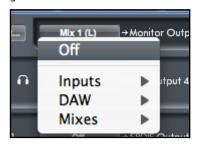
Mit einem Klick an der linken Seite der Box mit den Ausgangsbezeichnungen öffnet sich eine Liste mit allen verfügbaren Audioquellen.
