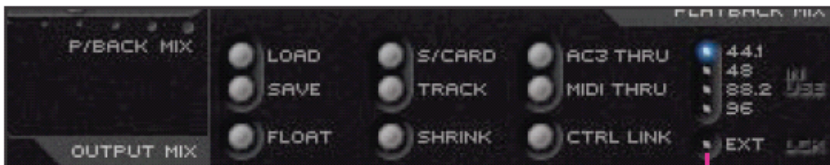
Botón de Sincronización Externa – pulsarlo para sincronizar a la señal S/PDIF
