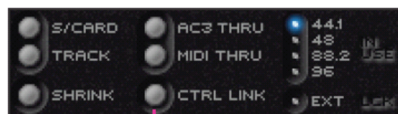
Botón CTRL LINK – permite vincular los controles de ganancia de todas las salidas analógicas (en el centro de la ventana)
