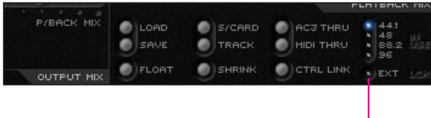
**Commutateur de synchronisation externe – engagé pour verrouillage sur le signal SPDIF entrant**
