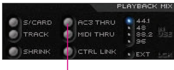
**Commutateur AC3 THRU – engagé pour diriger le signal encodé AC3/DTS vers la sortie SPDIF**
