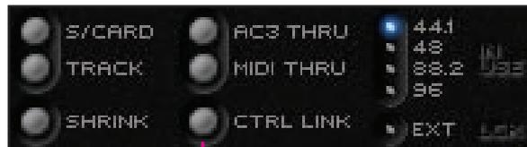
**Commutateur CTRL LINK – engagé pour le chaînage des contrôles de volume des sorties analogiques (au centre de la fenêtre)**
