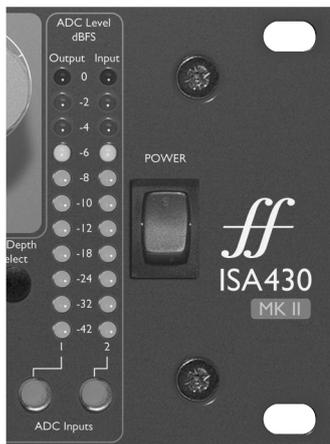
Due meters a LED visualizzano il livello in uscita (meter a sinistra) ed in ingresso (meter a destra) all'unità.
