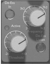
Il De Esser, basato su una circuitazione di tipo ottico, permette di eliminare l'eccessivo contenuto di sibilanti da una performance vocale.
