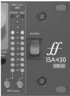
Zwei LED-Balken zeigen den Signalpegel des Ausgangs (linke Seite) und des Eingangs (rechte Seite) an.
