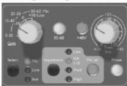
Es gibt drei Eingangsoptionen, kompatibel zu Mic-, Line- und Instrumentenquellen. Eine unbehandelte Eingangsstufe mit symmetrischem Ausgang (POST-MIC
