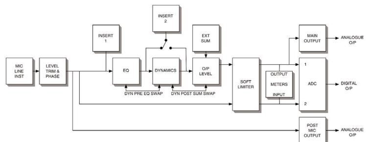
(Dans cet exemple, les deux sélecteurs ADC 1 et ADC 2 sont éteints et le Soft Limiter est activé.)
