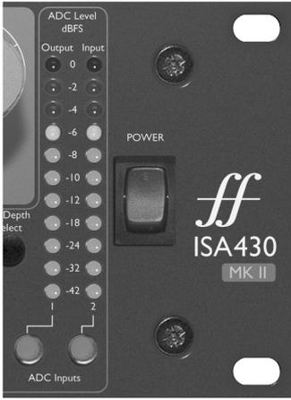
Ces deux rangées de Leds permettent de contrôler le signal entrant (rangée de droite) et le signal sortant (rangée de gauche). Elles permettent aussi de contrôler les niveaux de la carte A/N optionnelle quand les boutons ADC Input 1 et ADC Input 2 sont enfoncés. Les niveaux montrés s'échelonne entre -42dBFS (-20dBu) et 0dBFS (+22dBu).
