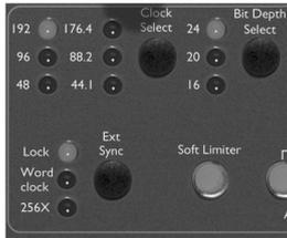
Appuyez pour activer le soft limiter. Le circuit va augmenter le ratio du limiteur proportionnellement au dépassement du threshold (-6dBFS / +16dBu). Entre -6dBFS et -4dBFS, le ratio est de 1.5:1 ; entre -4dBFS et 0dBFS, le ratio est de 2:1.
