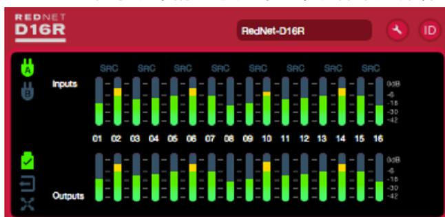
上图显示了具有所有输入和输出信号且没有接通SRC的RedNetD16R。设备正在使用PSUA，并被锁定到网络。
