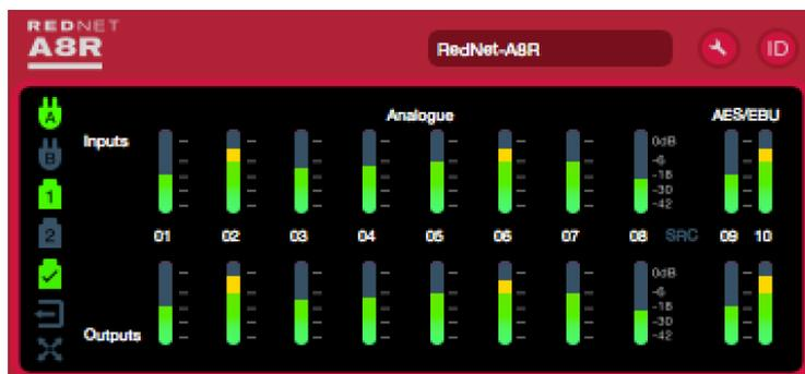
L'illustration ci-dessus montre un RedNet A8R avec des signaux présents sur tous les canaux d'entrée et de sortie. L'unité dispose d'une entrée d'alimentation unique, d'une entrée réseau unique et d'une connexion réseau verrouillée.
