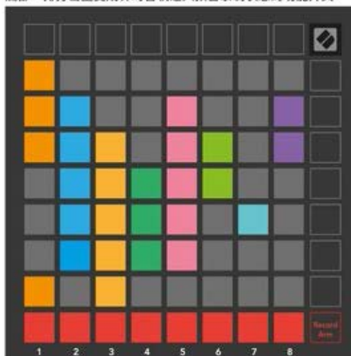
底部一排打击垫变成针对音轨进入预备录制状态的功能开关
