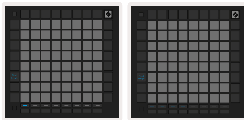
5.3.7.A – Choix du nombre de mesures avec les boutons de sélection de piste pour la fonction Fixed Length. L'image de gauche montre une durée fixée à 1 mesure, celle de droite une durée de 4 mesures.
