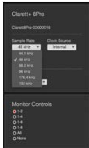
Tu interfaz Clarett+ puede funcionar con cualquiera de estas seis frecuencias de muestreo: 44,1 kHz, 48 kHz, 88,2 kHz, 96 kHz, 176,4 kHz y 192 kHz. La frecuencia de muestreo predeterminada es de 48 kHz. Si lo necesitas, selecciona otra frecuencia de muestreo. Ten en cuenta que la entrada óptica se desactiva cuando se utilizan frecuencias de muestreo de 176,4/192 kHz.
