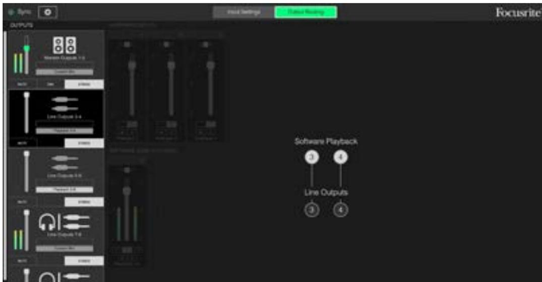
4. **Fader**: utilízalo para ajustar el nivel de señal en la salida. Ten en cuenta que los niveles de todas las salidas están al máximo de forma predeterminada (ganancia unitaria). Si el «dial» del fader está en verde, eso significa que el control del nivel de salida está asignado al control físico «**MONITOR**» del panel frontal de la Clarett+. Esta asignación se efectúa en la página «**Input Settings**»; consulta la página 26.
