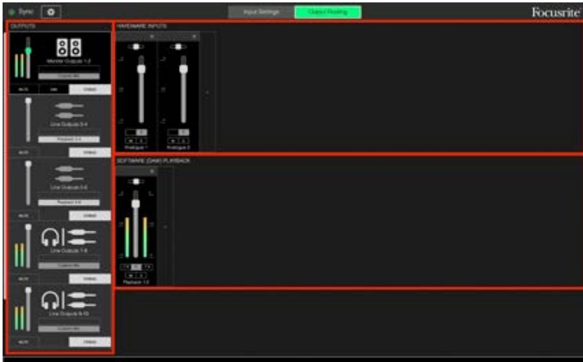
Focusrite Control tiene dos páginas: «Input Settings» (configuración de entradas) y «Output Routing» (enrutamiento de salidas). Las páginas se seleccionan con las pestañas situadas en la parte superior de la ventana. La mayor parte del tiempo utilizarás la página «Output Routing».
