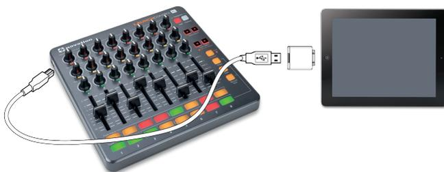
**注意：**Launch Control XL を iPad と使用する際には、まず、低電力モードに切り替える必要があります。これを行うには、User と Factory Template ボタンを押しながら USB ケーブルを接続します。Template ボタンから指を離し、「Record Arm」を押します。\*最後に、右の矢印ボタンを押します。
