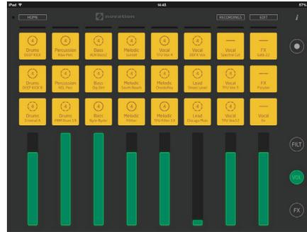
**Volume** : chaque colonne de 8 pads se transforme en fader de volume. Pressez le pad de la rangée B pour réinitialiser le volume.
