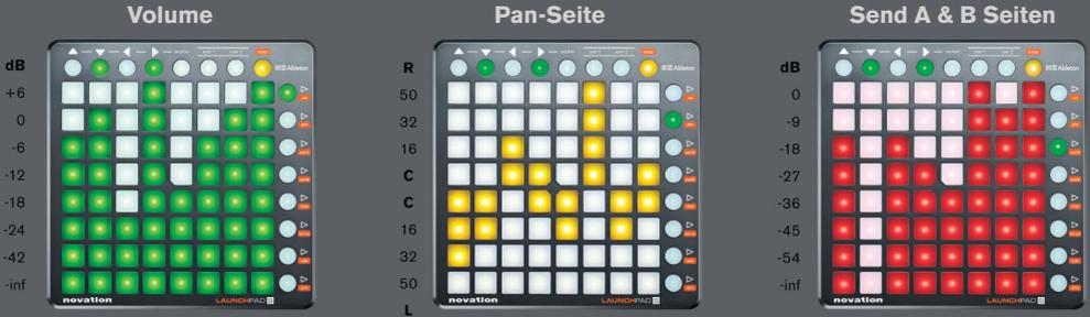
Wenn der Mixer-Modus aktiv ist, drücken Sie die Tasten Vol/Pan/SndA oder SndB, um auf die Volume-, Pan- oder Send-Seiten zuzugreifen: In diesem Modus arbeiten alle acht Pads in einer Spalte als stufenlose Track-„Fader“ für den gewählten Parameter.
