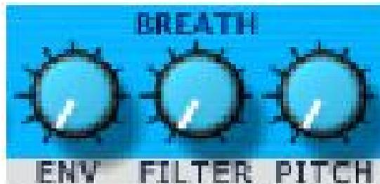
上記のアフタータッチと同じパラメーターになっています。これらのコントロールでブレスがボリューム、フィルターカットオフ、LFO に対してどの程度影響を与えるかを設定します。
