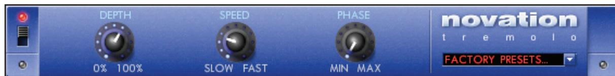
Le trémolo est une fluctuation rapide du niveau d'un signal, souvent entendue dans des solos instrumentaux tels que sur un violon. Il sert parfois à tort à décrire une ondulation de hauteur. Ici, le gain du signal entrant est modulé par une onde sinusoïdale d'amplitude et de fréquence variables. Il existe aussi la possibilité de retarder la modulation sur le canal droit pour créer un effet de panoramique intéressant.
