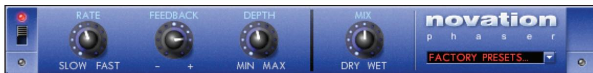
Un phaser fonctionne de la même façon qu'un effet chorus, simplement plutôt que de moduler le retard du son d'origine, il module sa phase (point de départ sur la forme d'onde). Une portion du signal audio est fractionnée et sa phase décalée à une certaine fréquence. Elle est ensuite re-mélangée avec le signal d'origine pour produire cet effet de chuintement caractéristique.
