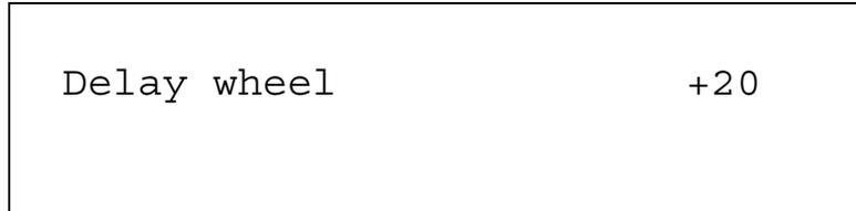
Dieser Parameter ist „Delay wheel“ mit Wert +20. Dieser Parameter steuert die Wirkung des Modulationsrades auf das Delay. Mit dem oberen Datenregler passt man diesen Parameter an. In der Minimalposition reduziert sich die Klangverzögerung, in der Maximalstellung wird sie erhöht. Der Parameterbereich ist –64 bis +63. Diesen Parameter speichert man mit dem jeweiligen Programm im Programm-Modus resp. mit der Performance im Performance-Modus, je nach Einstellung des „Part FX“-Parameters.
