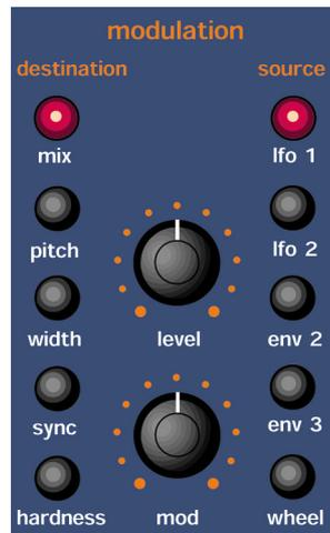
Mit der Betätigung eines Tasters für die gewünschte Quelle (Tasterreihe rechts) und des Tasters für das Modulationsziel sowie den Regeleinstellungen „Level“ und „Mod Depth“ lassen sich komplexe Modulationseinstellungen aufrufen.
