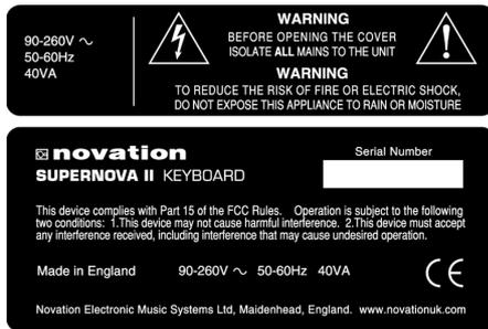
Der leuchtende Blitz mit Pfeilspitze innerhalb eines gleichzeitig Dreiecks warnt den Benutzer über das Vorhandensein unisolierter gefährlicher Spannungen im Inneren des Gerätegehäuses, die von ausreichender Höhe sein können, einen elektrischen Schlag zu verursachen.
