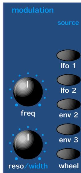
Dies ist ein extrem leistungsfähiger Bereich des SuperNova II Keyboard. Diese Regler beeinflussen die Filtermodulation. Die Taster auf der linken Seite sind „Modulationsziele“. Sie alle kann man mit den „Modulationsquellen“, d.h. mit den Tastern auf der rechten Seite manipulieren. Die Modulation von Quellen erfolgt mit dem Mod Depth-Regler. Dies kann eine positive Modulation sein (Drehung im Uhrzeigersinn) oder eine negative (Drehung im Gegenuhrzeigersinn).
