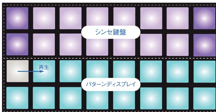
鍵盤は 2 オクターブで構成され、濃い紫色のパッドはそれぞれ最低ノートと最高ノートを表します。リアルタイムにシンセを演奏することでノートを追加するか、**Record** [12] を押してパターンにノートを追加することができます。録音ボタンが点灯している間は、いずれのシンセビュー (**Synth 1** または **Synth 2**) で演奏されたものも全てパターンに追加されます。
