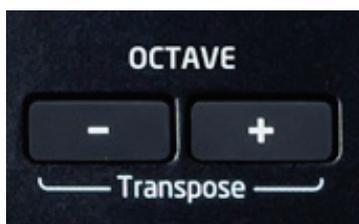
Presser simultanément les touches **Octave + / Octave -** [12] vous permet de transposer le clavier par demi-tons, jusqu'à un maximum de +/-12 demi-tons. L'écran à DEL clignote et confirme la transposition.
