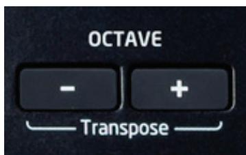
Les touches **Octave + / Octave -** [12] transposent le clavier vers le haut ou le bas par octaves. Le nombre d'octaves dont le clavier peut être transposé dépend du modèle de Launchkey :
