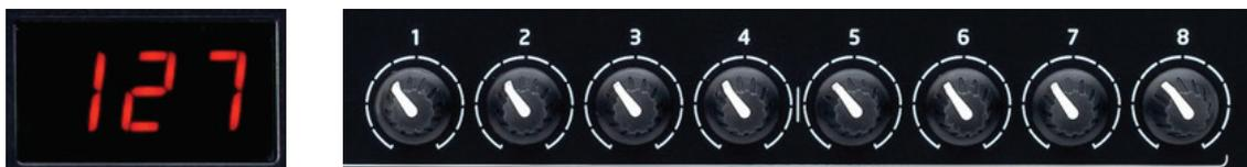
Tous les modèles ont huit boutons [6] qui, comme les autres contrôleurs du Launchkey, peuvent être utilisés en mode InControl ou en mode d'affectation de base. En mode InControl, ils fonctionnent généralement comme commandes de panoramique pour un jeu de huit canaux dans la section de mixage de la STAN. En mode d'affectation de base, chaque commande rotative transmet un message CC MIDI fixe. Voir les tableaux MIDI à partir de la page 19.
