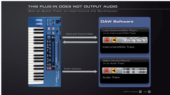
**ANMERKUNG:** Beachten Sie, dass der UltraNova Editor zwar ein Instrumenten-Plug-In ist, aber kein Audiosignal, sondern Controller-Daten ausgibt. Das Audiosignal selbst wird im UltraNova erzeugt, weshalb zur Audio-Wiedergabe/Aufnahme in der Musik-Software ein eigener Audiokanal benötigt wird.
