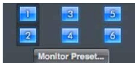
Über diese Tasten wählen Sie, welche analogen Ausgänge des Scarlett 18i8 (die Monitor- sowie die beiden Kopfhörer-Ausgänge) über die GUI-Regler in der Monitorsektion bedient werden.
