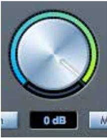
Betätigen Sie diesen Regler mit der Maus, um den Pegel in allen gewählten Ausgängen zu steuern. Die numerische Anzeige darunter gibt den aktuellen Monitor-Ausgangspegel an.
