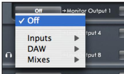
Mit einem Klick an der linken Seite der Box mit den Ausgangsbezeichnungen öffnet sich eine Liste mit allen verfügbaren Audioquellen.
