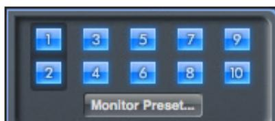
Die Monitor Control Enable Schalter zeigen, welche Ausgänge über die Monitorsektion in der GUI unter den zehn Schaltern gesteuert werden. Liquid Saffire 56 kann so konfiguriert werden, dass Sie diese Lautstärkeregelung auch an der Hardware vornehmen können. Abhängig von Ihrem Monitor-Setup können Sie entweder keinen Lautsprecher, ein einzelnes Lautsprecherpaar oder bis zu zehn Lautsprecher gleichzeitig adressieren.
