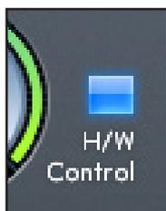
Wenn dieser Schalter leuchtet, steuert der Monitorregler an der Frontseite des Gerätes die Monitorlautstärke. In diesem Fall ist die Maussteuerung deaktiviert.
