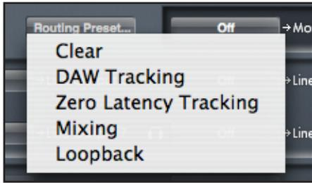
Die Routing-Voreinstellungen sind als Ausgangspunkt für die Erstellung Ihrer eigenen Routing- und Mixer-Setups gedacht. Das ermöglicht Ihnen, schnell Routings für Aufnahme (Abhören Ihrer Eingänge), Mixing (senden der Signale zu Outboardequipment oder einem externen Mixer) oder internes Looping (Audio zwischen verschiedenen Anwendungen innerhalb des Computers routen) zu erstellen.
