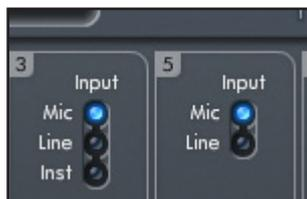
Die Signalquellen für die Eingänge 3-8 schalten Sie durch einen Klick auf die dazugehörigen Felder um. Für die Eingänge 3 und 4 kann zwischen Mikrofon- (Mic), Line- oder Instrumentpegel (Inst), bei den Eingängen 5 bis 8 nur zwischen Mikrofon- (Mic) oder Linepegel gewählt werden.
