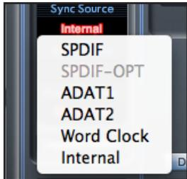
Hier wird die aktuelle Quelle des Syncsignals mit roter Schrift angezeigt. Um die Quelle zu ändern, klicken Sie auf die rote Anzeige und wählen Sie aus folgenden Möglichkeiten: SPDIF, SPDIF -OPT, ADAT1, ADAT 2, Word Clock oder Internal.
