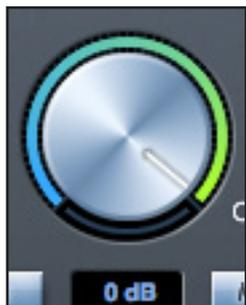
Mit diesem Regler werden die Pegel aller zugewiesenen Ausgänge geregelt. Der Ausgangspegel kann entweder mit der Maus oder an der Frontseite des Gerätes eingestellt werden. Das hängt von der Stellung des H/W Control-Schalters ab. Das darunter liegende "dB"-Display zeigt den momentanen, mit dem Monitorlautstärkereglер eingestellten Wert an.
