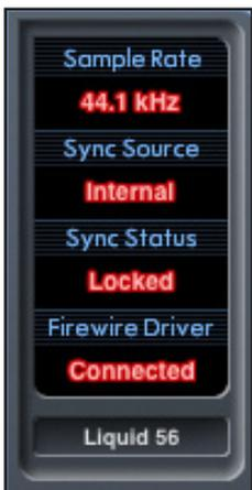
Die Gerätstatus-Sektion informiert über die Abtastfrequenz (Sample Rate), Synchronisation (Sync Source + Status) und Treiber (Driver) des Liquid Saffire 56. Die gewünschte Abtastfrequenz kann frei gewählt werden, ebenso die Optionen für die Synchronisation von Liquid Saffire 56 mit externen digitalen Geräten.
