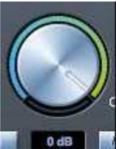
Bestimmt die Lautstärke aller zugeordneten Ausgänge. Die Lautstärke kann mittel der Maus in der Software oder am Gerätereuler eingestellt werden, abhängig vom Status des H/W Control Tasters.
