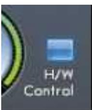
Wenn diese leuchtet ist der Regler an der Gerätefront für die Lautstärke-Einstellung zugeordnet, die Steuerung durch die Maus ist dann abgeschaltet.
