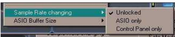
**Unlock** – Erlaubt jeder WDM- oder ASIO-Anwendung die Sample-Rate zu ändern.
