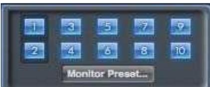
Diese Taster zeigen an, welche Ausgänge von der darunter befindlichen Monitorsektion beeinflusst werden. Der Saffire PRO 40 kann so eingestellt werden, dass Sie die Lautstärke von z.B. einem Paar Lautsprechern oder bis zu 10 Lautsprecher gleichzeitig regeln.
