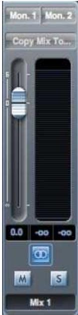
Auf den Ausgangskanal des Mixers sind alle Eingangskanäle geroutet und zusammengemischt. Der Ausgangskanalfader regelt die Gesamtlautstärke des Mixes. Der Mix kann zu jedem oder allen Hardware-Ausgängen gesendet werden. Wenn ein einziger Ausgang gewählt wurde wird dieser im oberen Bereich des Ausgangskanals angezeigt, sind mehrere ausgewählt wird "Many..." angezeigt.
