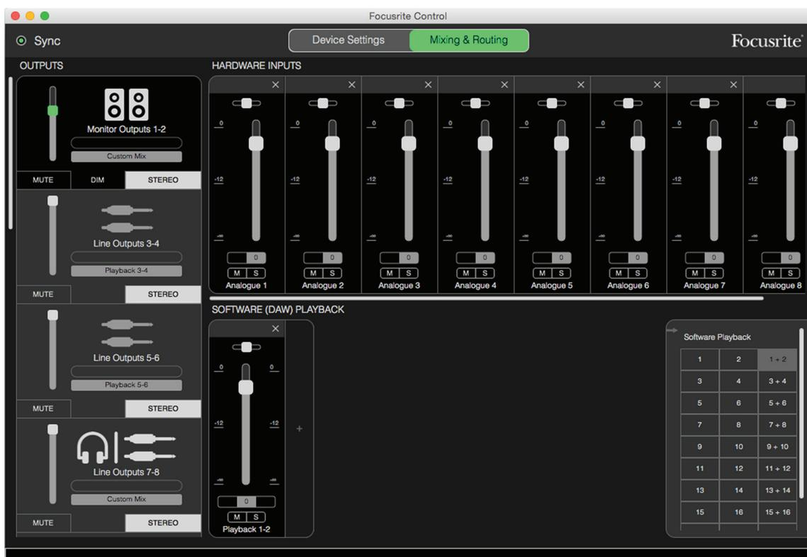
Comme avec le Preset 2 Channel Analogue, la sommation de sortie du mélangeur est envoyée aux sorties Monitor 1 et 2 et aux sorties ligne 7 à 10 sous forme de paire stéréo.
