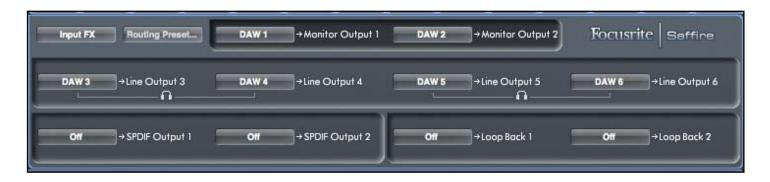
ルーティング設定部を使用して、どの入力ソースをハードウェアの各出力端子に出力するかを設定します。各出力の横に入力ソースを選択できるボックスがあり、クリックするとドロップダウン・メニューに選択可能な出力の一覧が表示されます。
