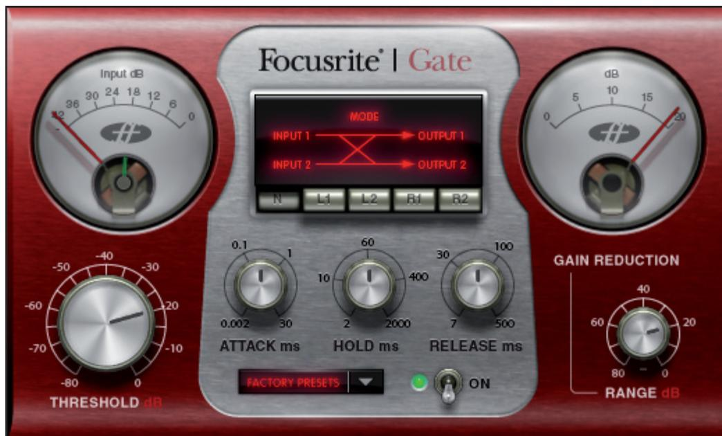
Un "Noise gate", souvent appelé simplement "Gate" c'est-à-dire porte en Français, est un outil utile pour supprimer les bruits de fond indésirables (leur "fermer la porte") ou simplement isoler les transitoires afin de créer des effets d'interprétation intéressants. L'action du Gate réduit ou coupe (coupe dans ce cas) tout signal chutant sous un certain niveau seuil (Threshold) afin que seules les sections les plus fortes soient entendues. Quand le signal est coupé, le Gate est dit "fermé".
