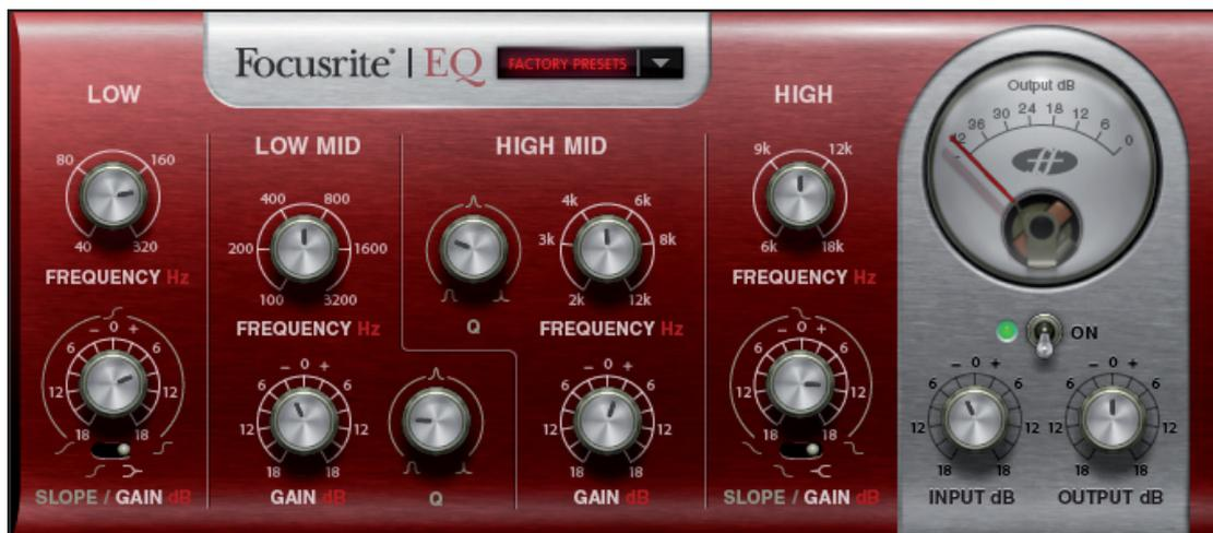
L'égalisation du son est une partie essentielle du processus d'enregistrement, nécessaire pour supprimer ou mettre en valeur diverses parties du spectre des fréquences audibles ! L'égaliseur Scarlett est paramétrique à 4 bandes avec l'option de faire fonctionner les bandes 1 et 4 en plateau et en filtres passe-haut/passe-bas, et il a les mêmes courbes que l'égaliseur classique Focusrite, tout ce qu'il vous faut pour sculpter le son avec une finesse vraiment professionnelle !
