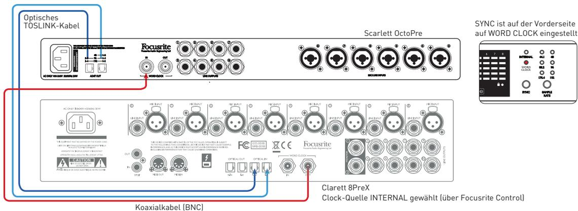
Dieses Setup entspricht im Wesentlichen dem Beispiel 2, allerdings ist in Verbindung mit einem Focusrite Clarett 8PreX auch ein Betrieb mit der Samplingrate 96 kHz möglich (Modus „SMUX-II“). Beide Geräte sind für 96 kHz konfiguriert und mit zwei optischen Kabeln zur Übertragung von jeweils vier Audiokanälen verbunden. Das Clarett 8PreX ist als Sync-Master konfiguriert.
