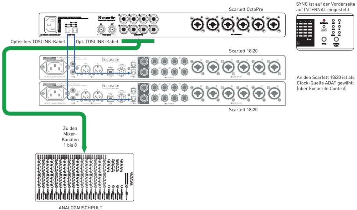
Dieses Beispiel zeigt, wie sich das Setup in Beispiel 4 erweitern lässt, um gleichzeitig eine digitale Aufnahme zu erstellen – wahlweise mit oder ohne Anlage einer Sicherung.
