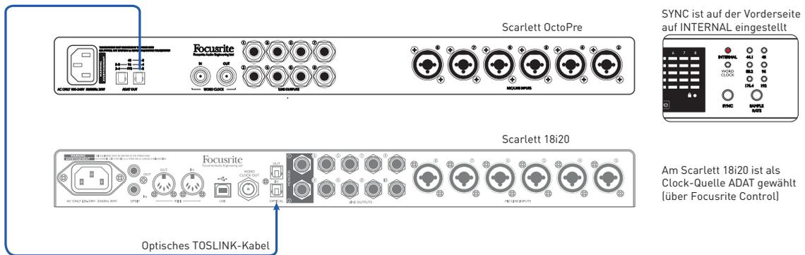
In diesem Beispiel ist der **OPTICAL OUT** am Scarlett OctoPre über ein einzelnes optisches Kabel mit dem **OPTICAL IN** eines Scarlett 18i20 Audio-Interfaces verbunden. Beide Geräte arbeiten mit einer Samplingrate von 44,1 kHz. Als Clock-Quelle ist im OctoPre INTERNAL und im 18i20 (über Focusrite Control) ADAT ausgewählt. Somit synchronisiert sich das 18i20 auf den OctoPre.
