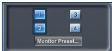
Die Monitor-Aktivierungstasten zeigen, welche Ausgänge über die Monitorsektion (in der grafischen Bedienoberfläche direkt unter diesen vier Tasten) gesteuert werden. Für Scarlett 8i6 kann eine Pegelsteuerung eingerichtet werden: Abhängig von der Konfiguration für das Monitoring kann die Lautstärke für ein Lautsprecherpaar oder auch für vier einzelne Lautsprecher gleichzeitig gesteuert werden.
