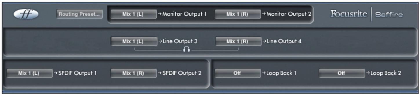
In der Routing-Sektion können Audioquellen direkt auf physikalische Ausgänge geroutet werden.
