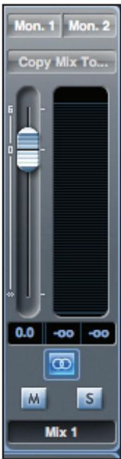
Alle Eingangskanäle werden auf den Ausgangskanal für den Mix geroutet und dabei gemischt. Der Ausgangskanal erlaubt die Aussteuerung der Gesamtlautstärke für den gesamten Mix. Ein Mix kann auf jeden einzelnen oder alle Hardwareausgänge parallel gespeist werden: Wenn ein einzelner Ausgang gewählt wurde, wird dieser über dem Ausgangskanal angezeigt. Wenn mehrere Ausgänge angewählt wurden, wird über dem Ausgangskanal „Many...“ eingeblendet.
