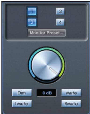
Die Ausgangspegel für die Monitor- und Line-Ausgänge werden in der Monitor-Sektion eingestellt. Scarlett 8i6 kann so konfiguriert werden, dass die Audiosignale an den Line-Ausgängen wahlweise über den Lautstärkereglern in der Software gesteuert, nicht über ihn gesteuert oder stumm geschaltet werden.
