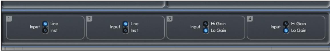
Weitere Linepegel-Signale können an den Eingängen 3 und 4 auf der Rückseite des Gerätes angeschlossen werden. Die Vorverstärkung (Gain) für die Eingänge 3 und 4 kann zwischen Lo (niedrig) oder Hi (hoch) umgeschaltet werden. Der maximale Eingangspegel (vor einer Signal-Übersteuerung) liegt bei:
