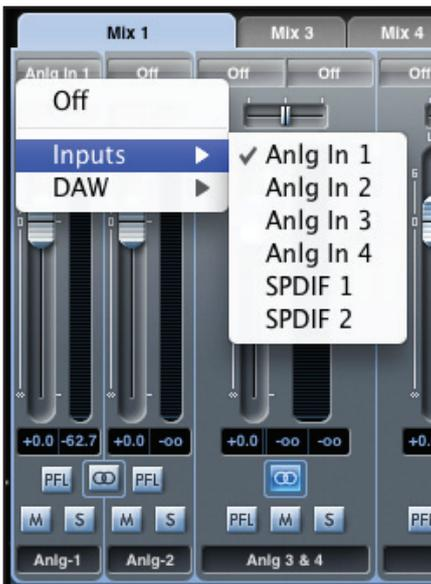
Mit einem Klick auf das Feld „Off“ wird eine Liste mit allen verfügbaren Eingängen geöffnet, die auf diesen Kanal geroutet werden können. Hier stehen alle analogen (mit ‚Anlg‘ bezeichneten) und digitalen (S/SPDIF) Eingänge sowie die DAW-Ausgänge zur Auswahl.
