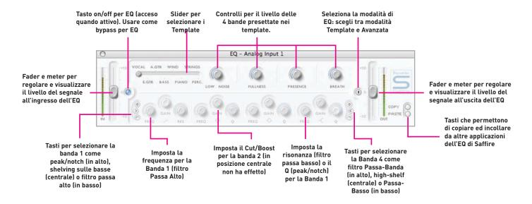
L'equalizzazione del suono è parte essenziale del processo di registrazione, necessario per rimuovere o aumentare varie sezioni dello spettro delle frequenze udibili. L'EQ di Saffire è parametrica a 4 bande, con l'opzione di un filtro shelving e passa alto/basso sulle bande 1 e 4, ed ha le stesse curve della classica EQ Focusrite; tutto ciò di cui avete bisogno per scolpire il suono con vero stile professionale!
