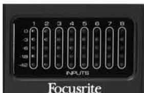
Los medidores LED 8 x 5 muestran el nivel de la señal justo antes que la misma alcance la conversión A/D - Después del preamplificador y del compresor.
