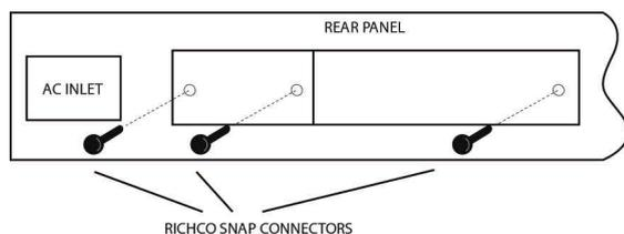
Der Schacht zum Einbau der Karte ist mit zwei kleinen Abdeckungen geschützt. Um diese zu entfernen, drücken Sie die drei Klick-Nieten von innen ein Stück heraus, um sie von aussen greifen und ziehen zu können.
