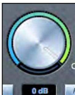
Avec cette commande, réglez le niveau de sortie de toutes les sorties assignées. Le niveau de sortie peut être réglé avec la souris ou la commande de la face avant, selon le statut du bouton de contrôle physique par l'interface (H/W Control). L'affichage en dB du dessous donne le niveau actuel de réglage de la commande Monitor.
