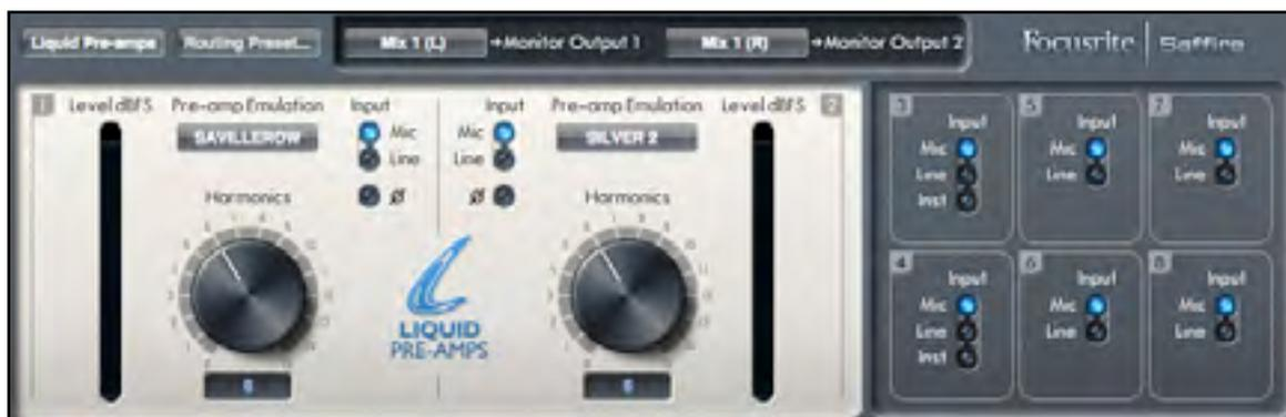
Les préamplis Liquid disposent de préamplis micro analogiques de haute qualité signés Focusrite. Après la conversion d'analogique en numérique, le signal audio passe au travers du DSP des préamplis Liquid. Le circuit analogique du préampli se commute sur les réglages d'impédance du préampli original émulé.
