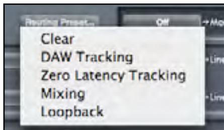
Des routages pré-réglés (Routing Presets) sont fournis comme point de départ pour que vous puissiez créer vos propres configurations de routage et de mixage. Ils vous permettront de rapidement configurer votre routage pour l'enregistrement (écoute de vos entrées), le mixage (envoi des signaux aux processeurs externes ou à une table de mixage externe) ou le bouclage de renvoi interne (routage audio entre applications sans sortie de l'ordinateur).
