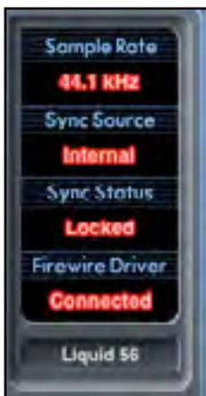
La section statut d'appareil affiche des informations sur la fréquence d'échantillonnage, la synchronisation et le statut de pilote de la Liquid Saffire 56. La fréquence d'échantillonnage désirée peut être réglée ainsi que les options de synchronisation externes pour l'emploi de la Liquid Saffire 56 avec des appareils numériques externes.
