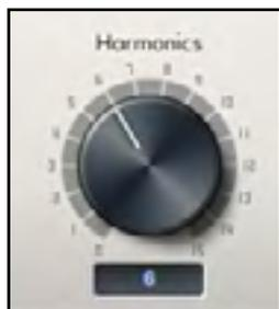
Tournez ce bouton dans le sens horaire pour ajouter au signal la distorsion harmonique souhaitable - souvent perçue comme une "chaleur" supplémentaire. La commande Harmonics vous permet d'ajouter ce type de distorsion et d'émuler les subtiles variations existant entre appareils analogiques - parfois, deux unités du même type peuvent avoir des taux de distorsion harmonique différents. Cela vous permet de créer un son "saturé" sans avoir à saturer le préampli.
