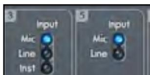
Sélectionnez la source des entrées 3-8 en cliquant sur les boutons correspondants. Les entrées 3 & 4 peuvent être réglées sur Mic (micro), Line (ligne) ou Instrument. Les entrées 5 - 8 peuvent être réglées sur Mic (micro) ou Line (ligne).
