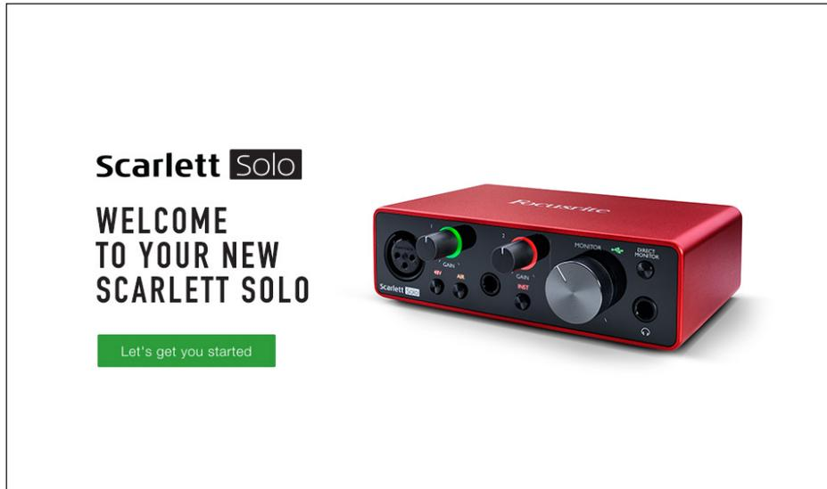
“Let's get you started” をクリックします。部分的にあらかじめ自動入力されたフォームが表示されます。フォームを送信すると、そのままダウンロードサイトに移動して Scarlett 用のソフトウェアを取得するか、手順に従ってセットアップを行うかを選択するように促すオプションが表示されます。Focusrite Control ソフトウェアをインストールして、インターフェイスのセットアップおよび設定を完了すると、Scarlett (は MSD モードから切り替わり、お使いのコンピューターに接続しても、マストレージデバイスとして表示されなくなります。
