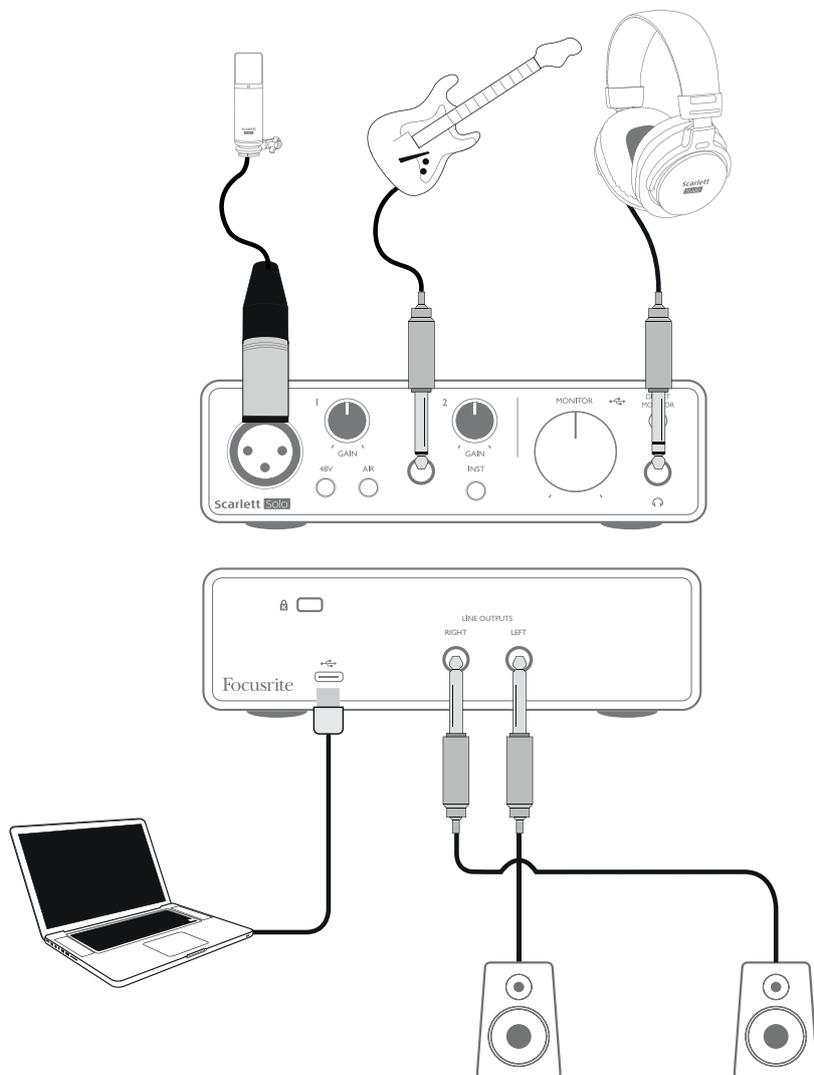
このセットアップは、お使いの Mac または Windows で DAW ソフトウェアを使用してレコーディングを行う際の一般的な構成を示しています。この場合、ヘッドフォンからの再生をモニタリングしながら、Input 1 でボーカルを、Input 2 でギターをレコーディングアプリケーションに録音できます。
