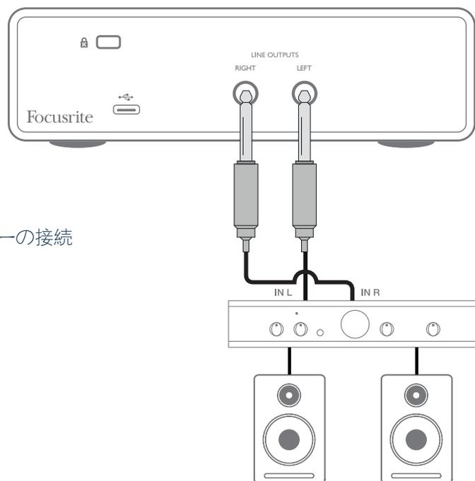
ライン出力は、3 極 (TRS) 1/4 インチ (6.35 mm) ジャックソケットで、電氣的にバランスがとれて (平衡して) います。一般的な民生用 (Hi-Fi) アンプや小電力モニターは、フォノ (RCA) ソケットまたはコンピュータに直接接続するように設計された 3.5 mm 3 極ジャックプラグのいずれかにアンバランス入力を備えています。いずれの場合にも、1 端にジャックプラグのついた適切な接続ケーブルを使用します。
