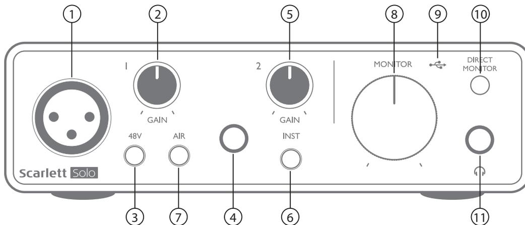
El panel frontal incluye conectores de entrada para señales de micrófono, línea e instrumentos y controles de ganancia de entrada y monitorización.
