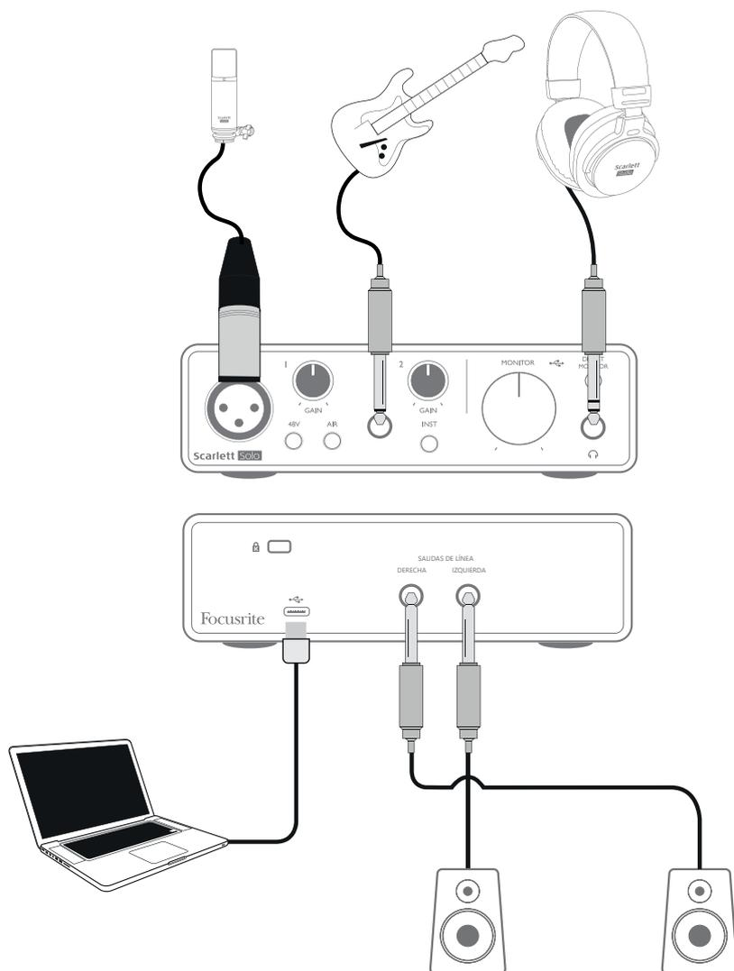
Esta configuración típica muestra las conexiones para grabar con la aplicación DAW en su Mac o PC. En este caso, grabará las voces a través de la entrada 1 y la guitarra a través de la entrada 2 en su aplicación de grabación, mientras monitoriza la reproducción a través de los auriculares.
