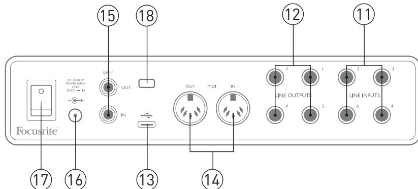
11. **LINE INPUTS 3–6** — четыре симметричных аналоговых линейных входа, выполненные в виде штекерных гнезд  $\frac{1}{4}$  дюйма (6,35 мм). К ним можно подключить дополнительные источники сигналов линейного уровня через гнезда  $\frac{1}{4}$  дюйма TRS (для симметричных сигналов) и TS (для несимметричных сигналов).
