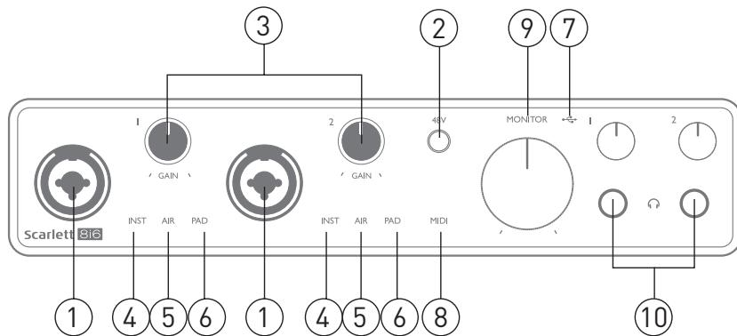
На передней панели располагаются входные разъемы для подачи сигналов микрофона, линейных сигналов и сигналов музыкальных инструментов, а также органы регулирования входного усиления, управления функцией мониторинга и гнезда для наушников.
