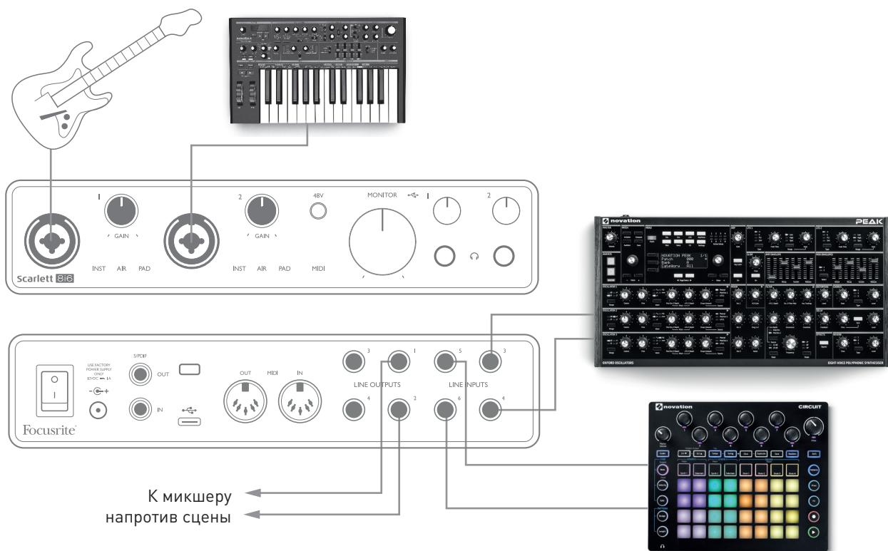
В приведенном примере гитара, стереофонический и монофонический синтезаторы и электронный грувбокс подключены к шести аналоговым входам Scarlett 8i6; выходы 1 и 2 подключаются к основной системе РА. Исполнитель может настроить необработанный микс в Focusrite Control, а затем отрегулировать уровни двух монофонических источников относительно стереофонических с передней панели.
