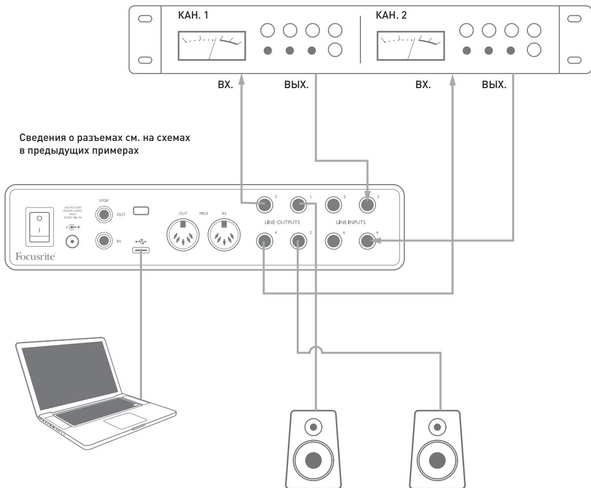
При необходимости с помощью Focusrite Control можно настроить уровни на входе и на выходе внешнего процессора.
