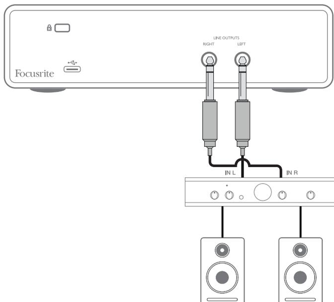
线路输出为 3 芯 (TRS) ¼" (6.35 mm) 电子平衡插孔型插口。典型消费类 (Hi-Fi) 放大器 and 小型有源监听扬声器只有非平衡输入 (位于唱机 (RCA) 插口或通过用于直接连接计算机的 3.5 mm 3 芯插孔型插头实现)。在这两种情况下, 使用一端带有插孔型插头的适用连接线。
