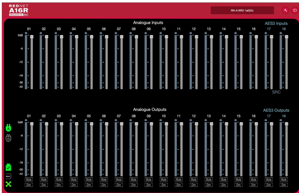
Das Bild zeigt die Schieberegler für die Pegelsteuerung, die Pegelanzeigen und die Mute/Dim-Tasten für jeden der 18 Ein- und Ausgänge.
