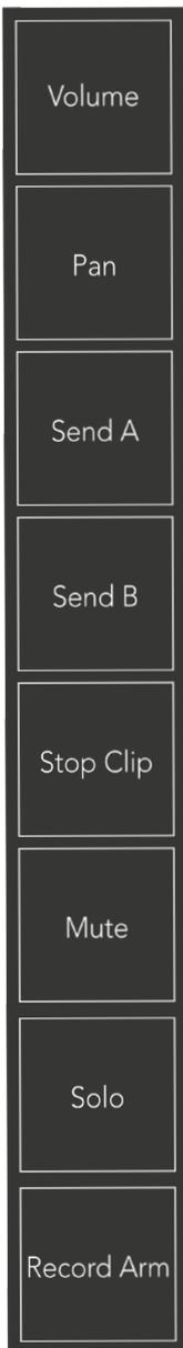
**Volume:** セッションビュー内で現在選択されている8x8のエリア内のトラックの音量レベルを制御します。ボリュームフェーダーは縦の列で示されます。
