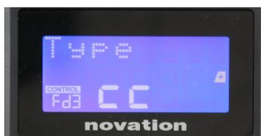
Manipuler n'importe quelle commande assignable – par ex. les faders 1-9\*, les boutons 1-9\*, les encodeurs 1-8 ou les pads de batterie – fait s'afficher le paramètre de cette commande. Le numéro de commande sélectionné est affiché, par exemple Fd3 (Fader 3) ou Bt5 (Bouton 5).
