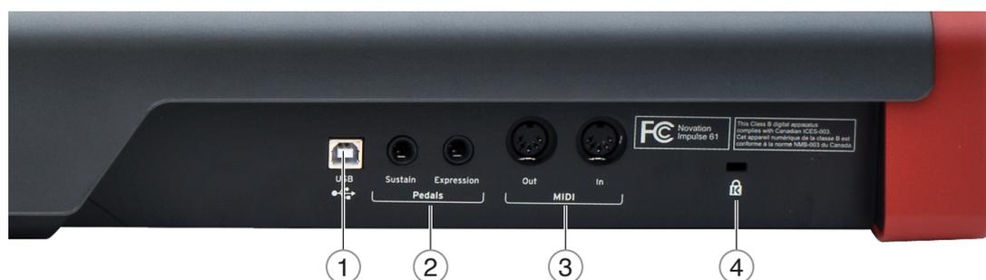
1 **Port USB** – connecteur USB de type B compatible avec l'USB 1.1, 2.0 ou 3.0. Raccordez l'Impulse à un port USB de votre ordinateur à l'aide du câble USB fourni. Sinon, vous pouvez brancher ici un adaptateur secteur USB CA-vers-CC si vous utilisez l'Impulse loin d'un ordinateur.
