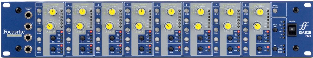
El ISA 828 MkII es un preamplificador de micrófono de ocho canales de alta calidad que se puede usar para grabar fuentes de micrófono, de nivel de línea o de instrumentos. Las fuentes de micrófonos y nivel de línea de las ocho entradas se conectan en el panel posterior, mientras que las entradas de instrumento, disponibles en los canales 1 a 4, se pueden conectar directamente en los enchufes del panel frontal.
