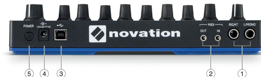
① **L/MONO 和 RIGHT 输出端口** – Circuit的主要音频输出端口是两个1/4” TS接口。最大输出电平+5.3 dBu (+/-1.5 dBu)。当**RIGHT**端口没有连接时，**L/MONO**端口负责传输左右声道信号的单声道混音输出。当这两个输出端口任意一个被连接，或者两个都被连接上时，内置的扬声器将处于静音状态。
