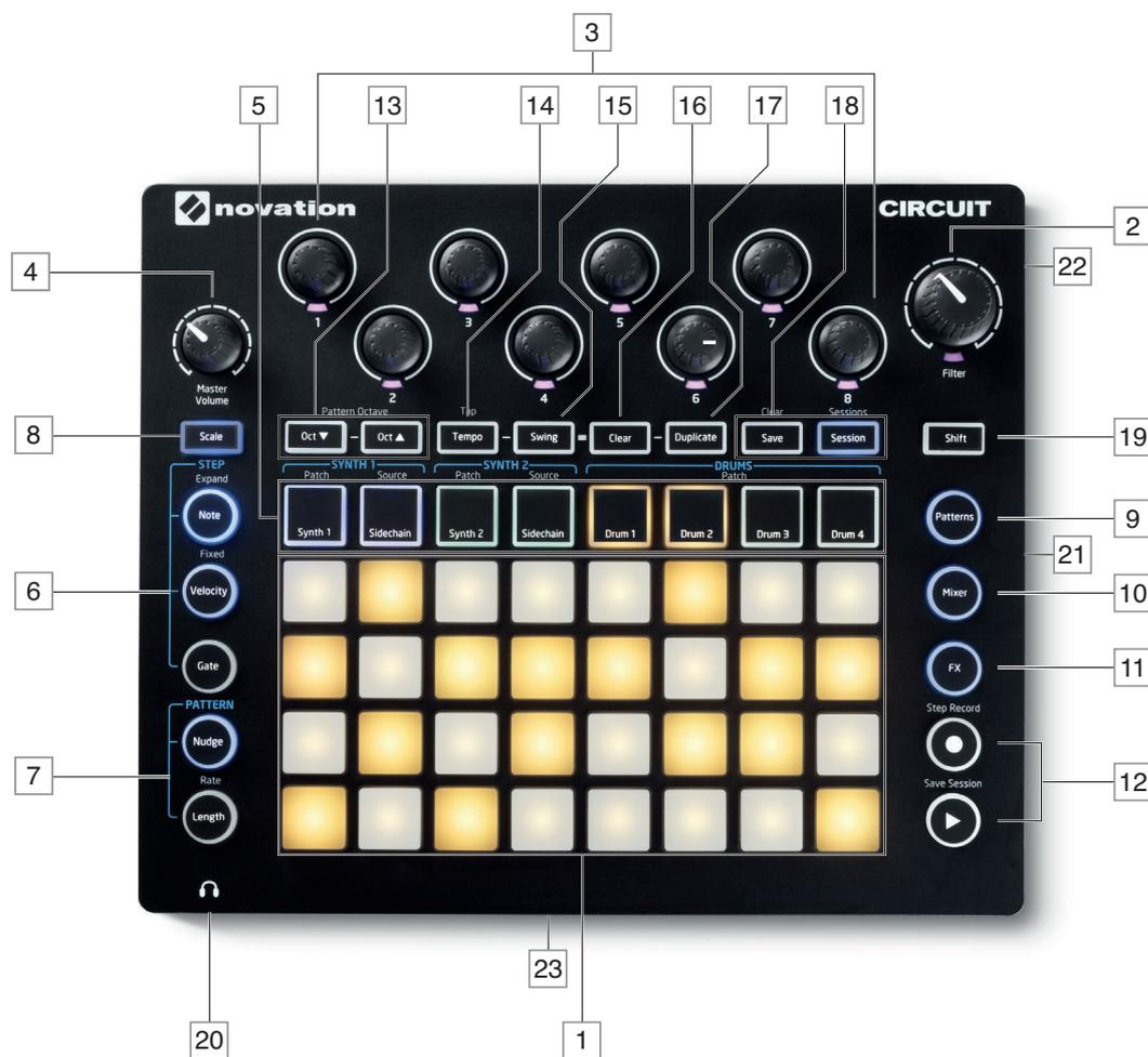
1 **32个打击垫组成的演奏网格** - 4 x 8矩阵排列的橡胶打击垫；内部通过RGB LED灯发光。按照所选用的功能界面不同，网格会拆分成对应不同功能的逻辑区间。
