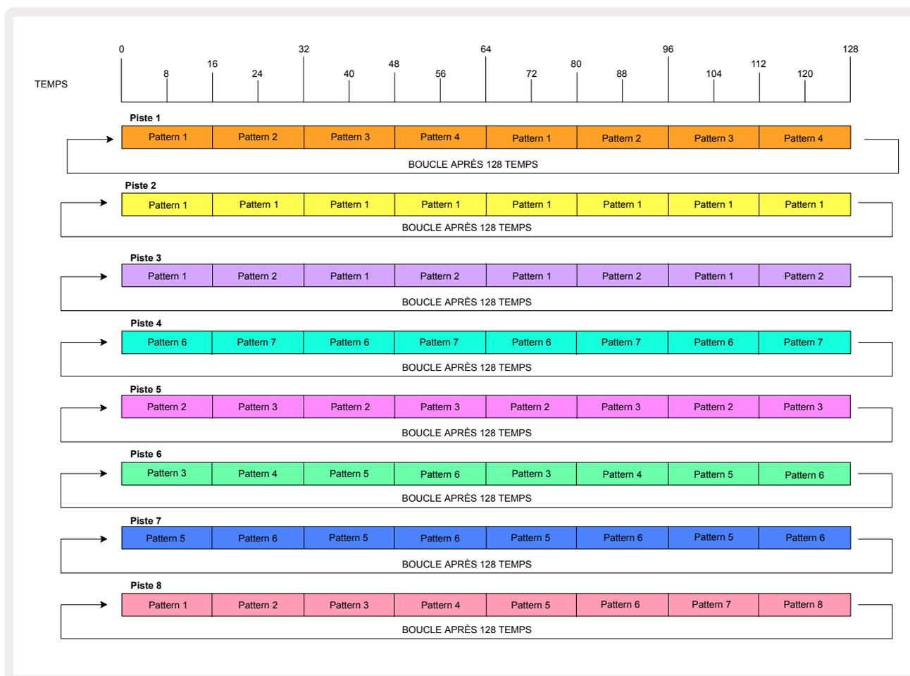
L'exemple ci-dessus illustre les éléments basiques concernés quand vous chaînez des Patterns pour créer une séquence plus longue. Créer des séquences plus longues, complexes et originales est une extension de ces principes. Le Circuit Rhythm permet de créer des chaînes de Patterns de 256 (8 x 32) pas au maximum, les patterns de n'importe laquelle des huit pistes pouvant changer tous les 16 pas (ou moins si vous modifiez les points de début/fin par défaut).
