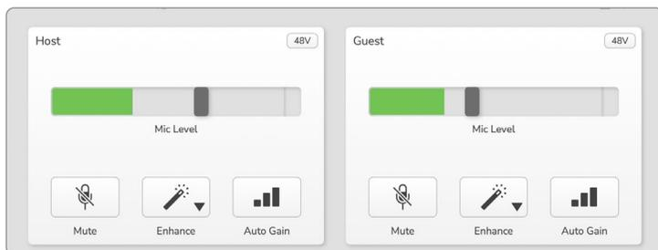
两个话筒各自的输入信号电平表**Mic Level**，其工作模式都是一样的。每个话筒对应一个电平表和一个电平控制器。点击并拖拉软件上的滑动条可以调节增益。该调节功能与声卡上的物理增益旋钮是一样的，所以您可以选用任一方式来调节增益。
