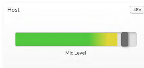
Recomendamos usar el control automático de ganancia para ajustar el nivel del micrófono. Si se produce distorsión o el micrófono está muy alto, puedes utilizar el medidor para conseguir el nivel adecuado.
