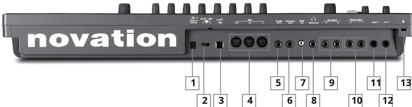
{1} **Connettore di alimentazione CC**: presa standard da 2,2 mm per il collegamento dell'alimentatore esterno 12 V CC (in dotazione). Vedere pagina 3.
