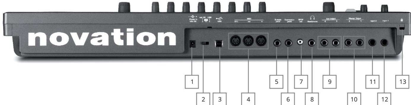
{1} DC konektor za napajanje: standardna utičnica od 2,2 mm za spajanje vanjskog 12 V DC PSU (isporučeno). Pogledajte stranicu 3.
