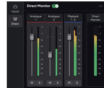
Direct Monitor aan en Analooq 2 verlaagd in niveau
