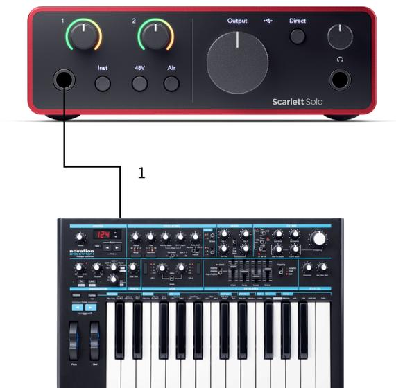
1. Conecte dispositivos de nível de linha, como sintetizadores, teclados ou pré-amplificadores de microfone à entrada **1** usando uma entrada de tomada de 6,35 mm no painel frontal. Ao conectar um dispositivo de nível de linha, use um cabo de tomada TRS de 6,35 mm a 6,35 mm, mas observe que a entrada é mono. Desative o **Inst** ao conectar dispositivos de nível de linha ao Scarlett Solo.
