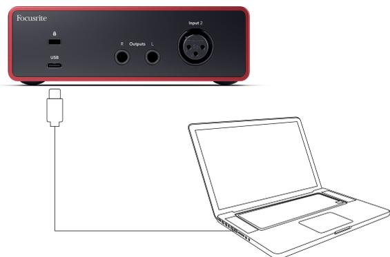
A conexão com seu computador fornece energia USB, comunicação de áudio bidirecional e uma conexão para Focusrite Control 2.
