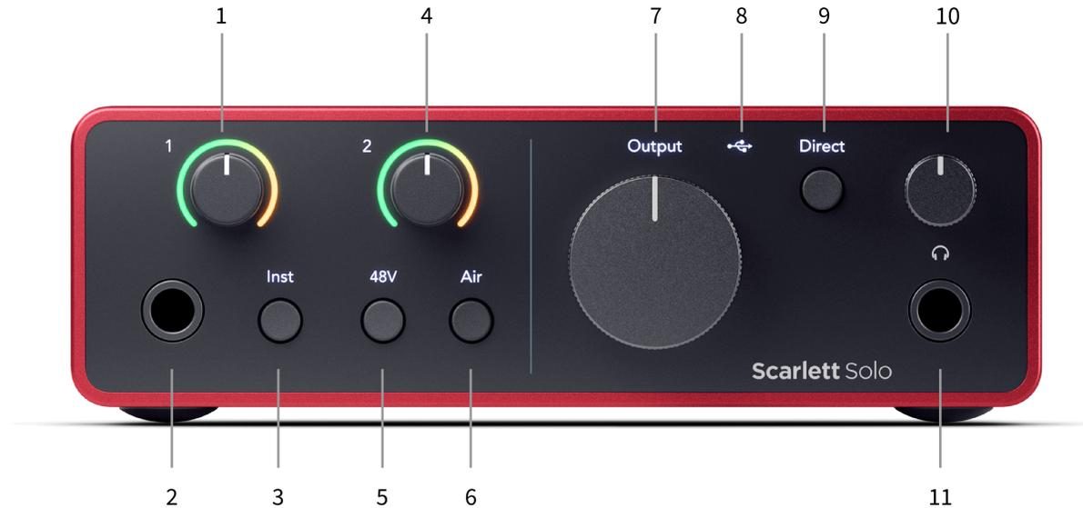
1. Entrada **1** (Nivel de Línea/Instrumento) Control de ganancia y halo de Ganancia - El control de ganancia ajusta el nivel de entrada y el halo de ganancia le muestra el nivel de entrada para la entrada de nivel de línea/instrumento del conector jack de 6,35 mm (1/4"") en el panel frontal.
